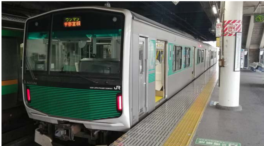
図 1.4: 蓄電池電車の導入例 (筆者撮影)
