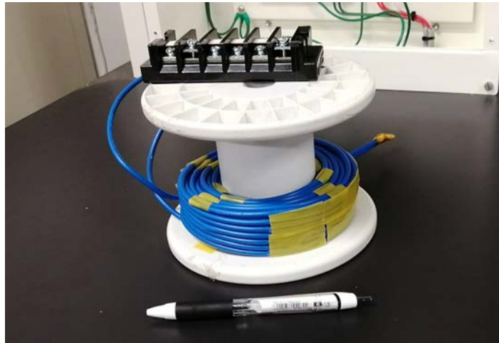
図 4.6: 設計・製作した空心リアクトルの外観図
