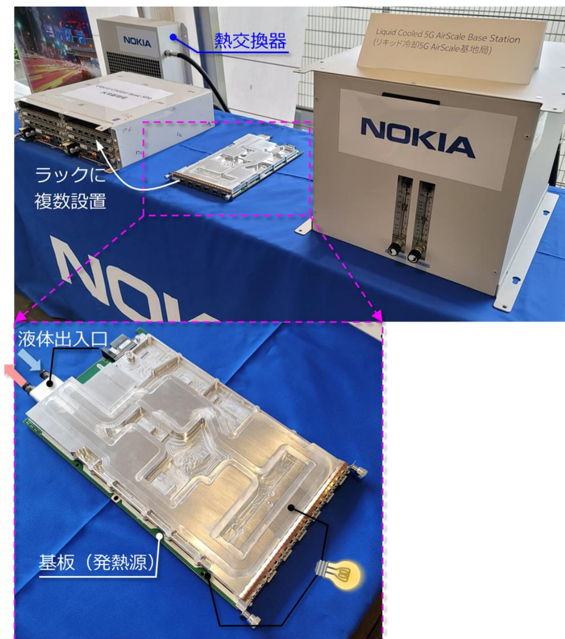
Fig. 1.25 Nokia 社が開発した水冷式の 5G 基地局基板部とレドックスフロー熱電変換の適用模式図。Nokia 社の Web サイト [115] および ASCII.jp の Web サイト [116] から引用した写真に、筆者が説明等を追記した。
