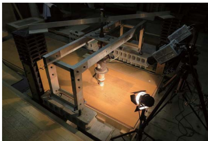
写真 2.1 仕様変更後の測定装置による変形挙動の測定状況の例
