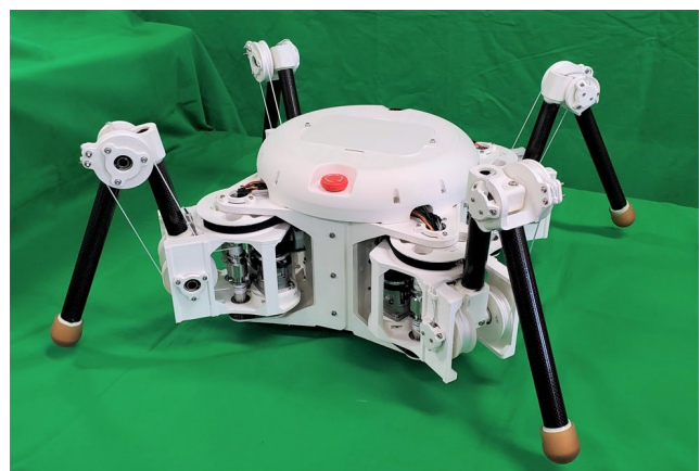
図 1 高強度化学繊維ロープを用いたロボット (左: ワイヤ干渉駆動型超長尺多関節アーム Super Dragon, 右: 四脚歩行ロボット TITAN-E1)
