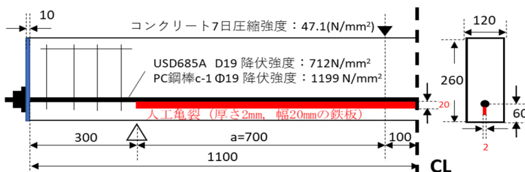
図-7 試験体概要 (図は 1-under)
