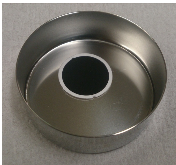
写真 2-8 球形粒子密度算出のための模擬浮遊粒子捕集済み石英フィルター
