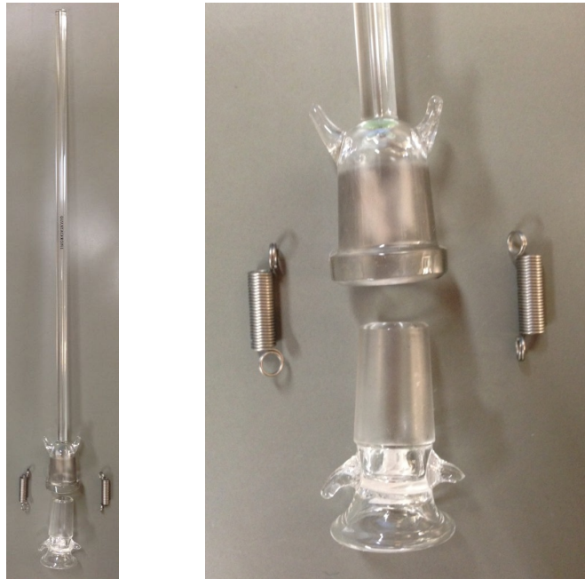
写真 2-10 パウダーセル（各写真中の上部：セルシステム，下部：球状試料室）
