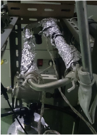
写真 2-5 ミスト含有空気加熱部（リボンヒーター）とディフュージョンドライヤー外観
