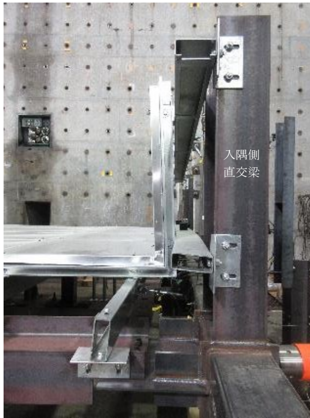
写真4.5 入隅周辺の間柱断面の局所的な変形の様子
