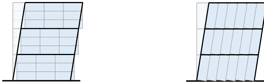
(a) スライド方式(横張り工法) (b) ロッキング方式(縦張り工法)
