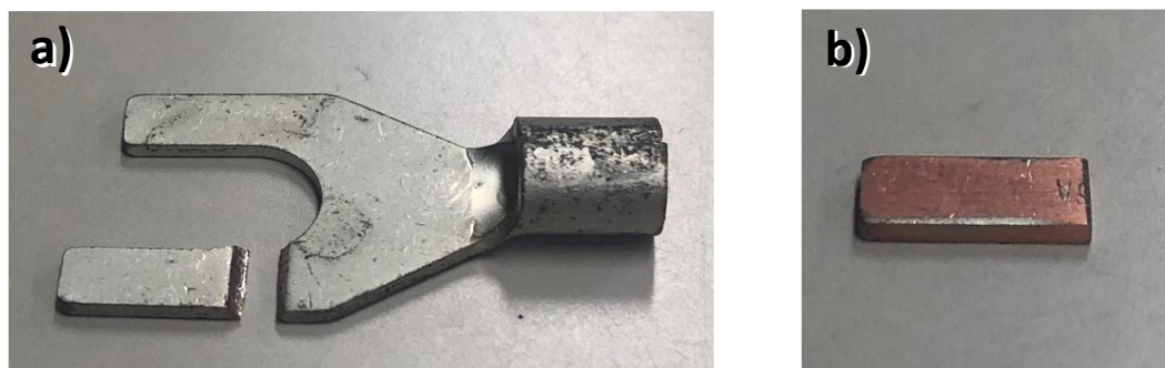
図2-2-2 CP基材の a)切り離し,および b)被覆層除去
