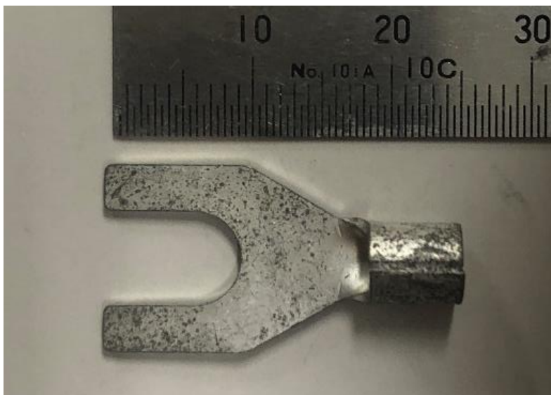
図 2 - 2 - 1 CP 基材に用いた Y 型圧着端子
