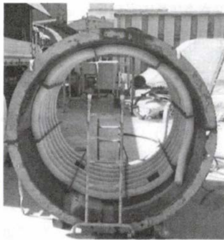
図 2.4.2.3 トンネル一次覆工の形成実験状況
