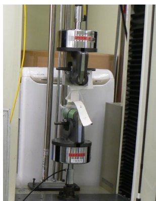
図 2.2.3.3 引張試験状況
