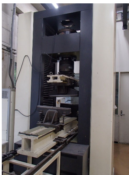
図 2.2.2.6 曲げ試験用载荷装置 ((株)島津製作所 AG-300kNX)
