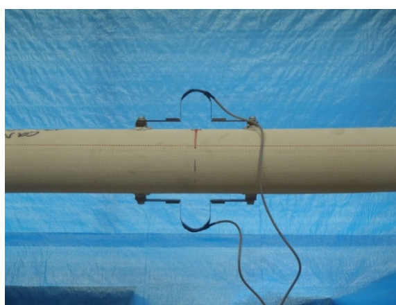
図 2.2.2.9 パイ型変位計 ((株)東京測器研究所 PI-2-150)
