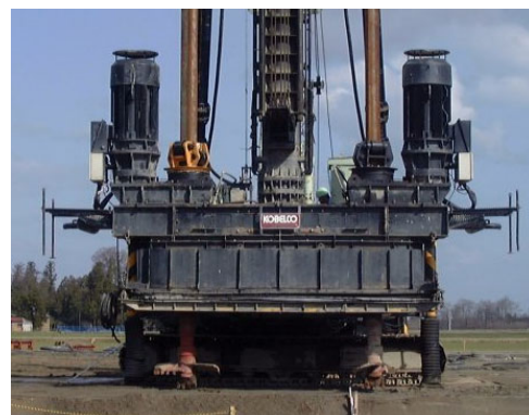
図 1.2.1.6 スラリー混合方式（左）と粉体混合方式（右）の施工機械
