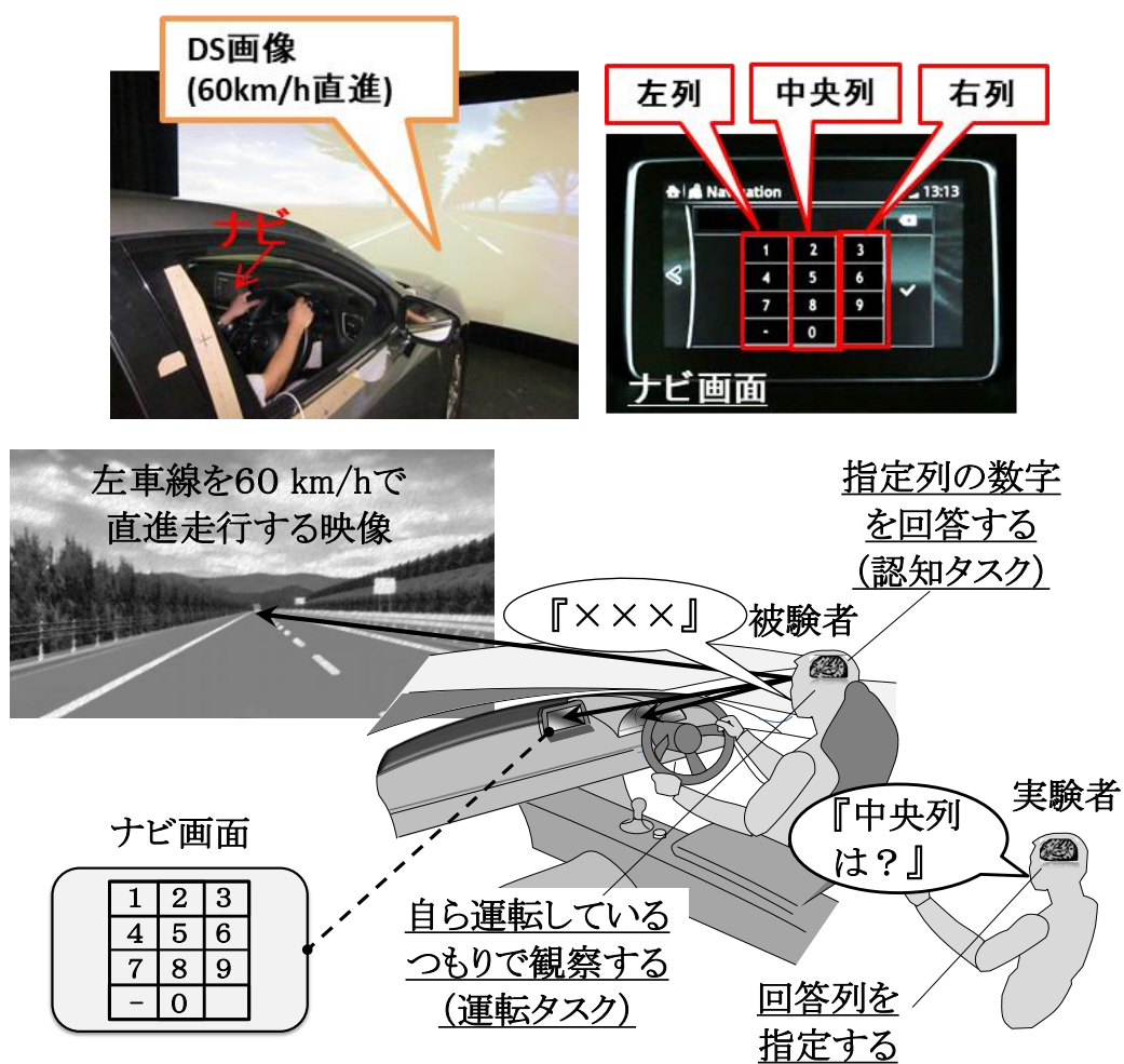
図 6.5 実験風景とナビ画面（上段），および実験システムの概要図（下段）。
