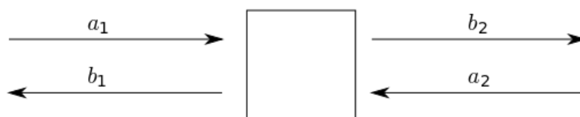
図 1.15 S パラメータの概略図
