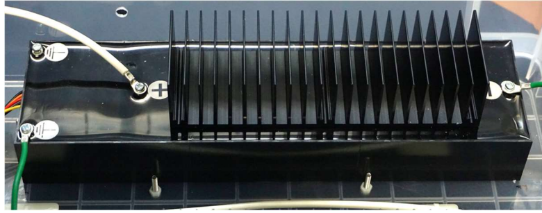
図 3.13: 高圧短パルス生成用 MOS-FET (18 kV, 250 A)
