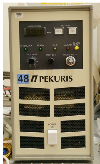
図 3.7: パルス電源 (4 kV, 5 A p , 2–200 kHz)
