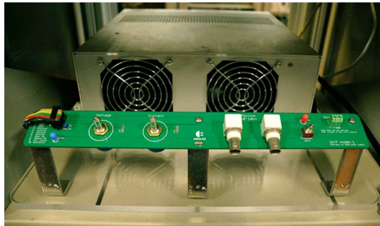
図 3.6: 直流安定化電源 (1 kV, 1.2 A)
