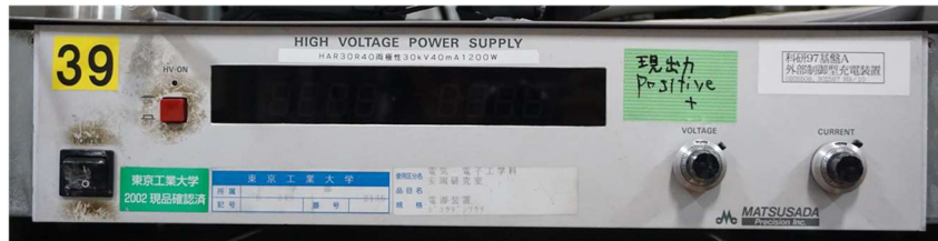
図 3.8: 安定化電源 (30 kV, 40 mA)
