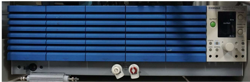
図 3.5: 直流安定化電源 (320 V, 25 A)
