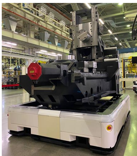
搬送用大型 AGV の実装事例
