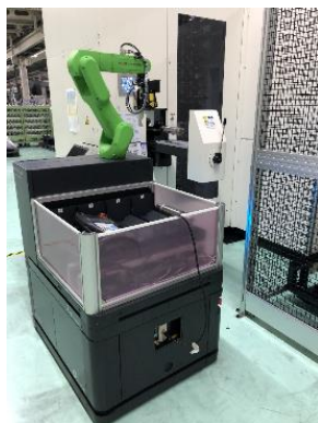
図 3. 29 マシニングセンタの工具交換に実際に適用された Mobile Robot
