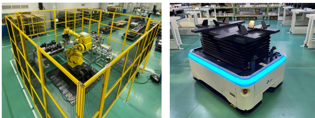
図 3. 42 ボールねじサブユニット組立セルと搬送用 AGV
