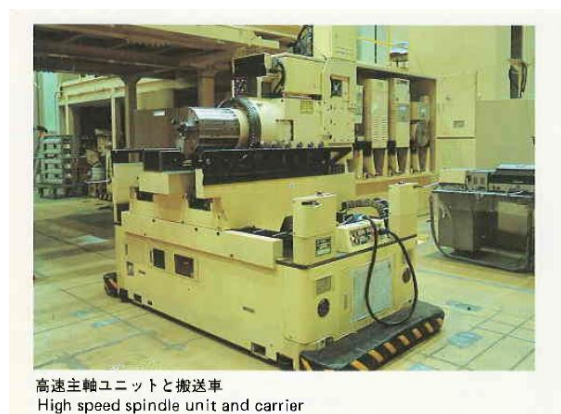
図1. 9 主軸頭ユニットと搬送 AGV
