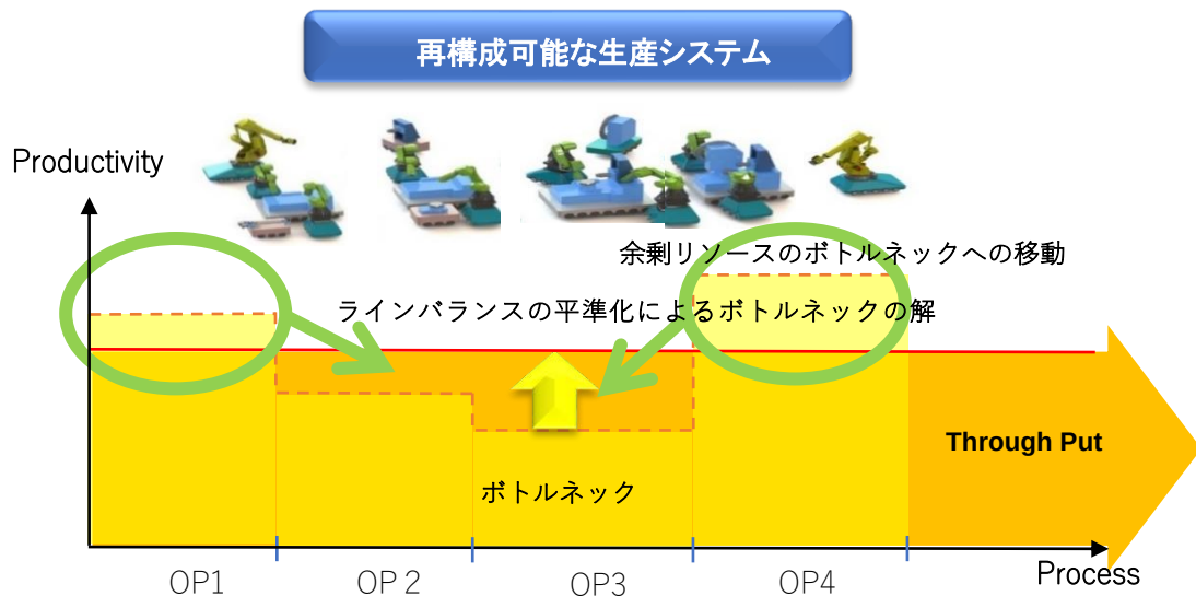
図 2. 3 工作機械の組立生産システムの再構成によるボトルネックの平準化
