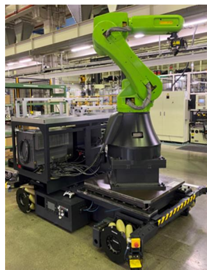
大型協働多関節ロボットを搭載した 大型 Mobile Robot の実装事例
