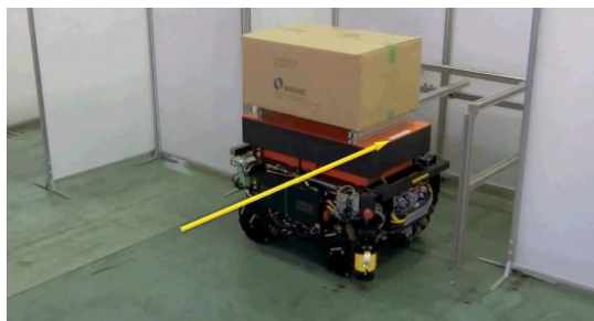
図 3. 25 Lifter による荷物自動運搬
