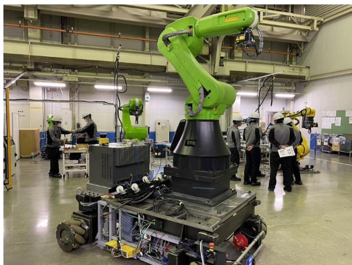
図 1. 1 2 組立用協働型 Mobile Robot
