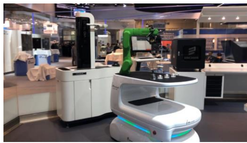
図 3. 26 FMS への自動工具供給
