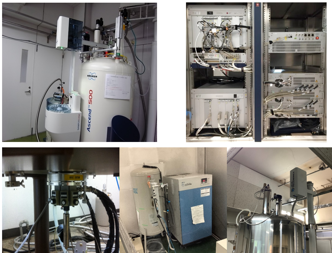
図4-2-1 NMR 主要構成 上段左：①超電導磁石、上段右：②分光計 下段左：③検出器、下段中央：⑤コンプレッサー、下段機右：⑥液体窒素蒸発抑制装置
