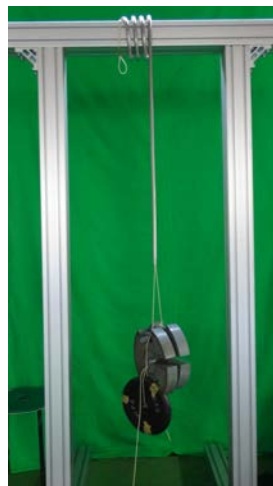
図 4: 螺旋導管引張実験
