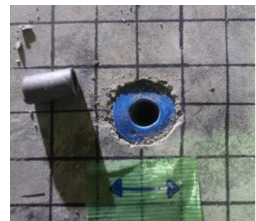
(f) インサート破断
