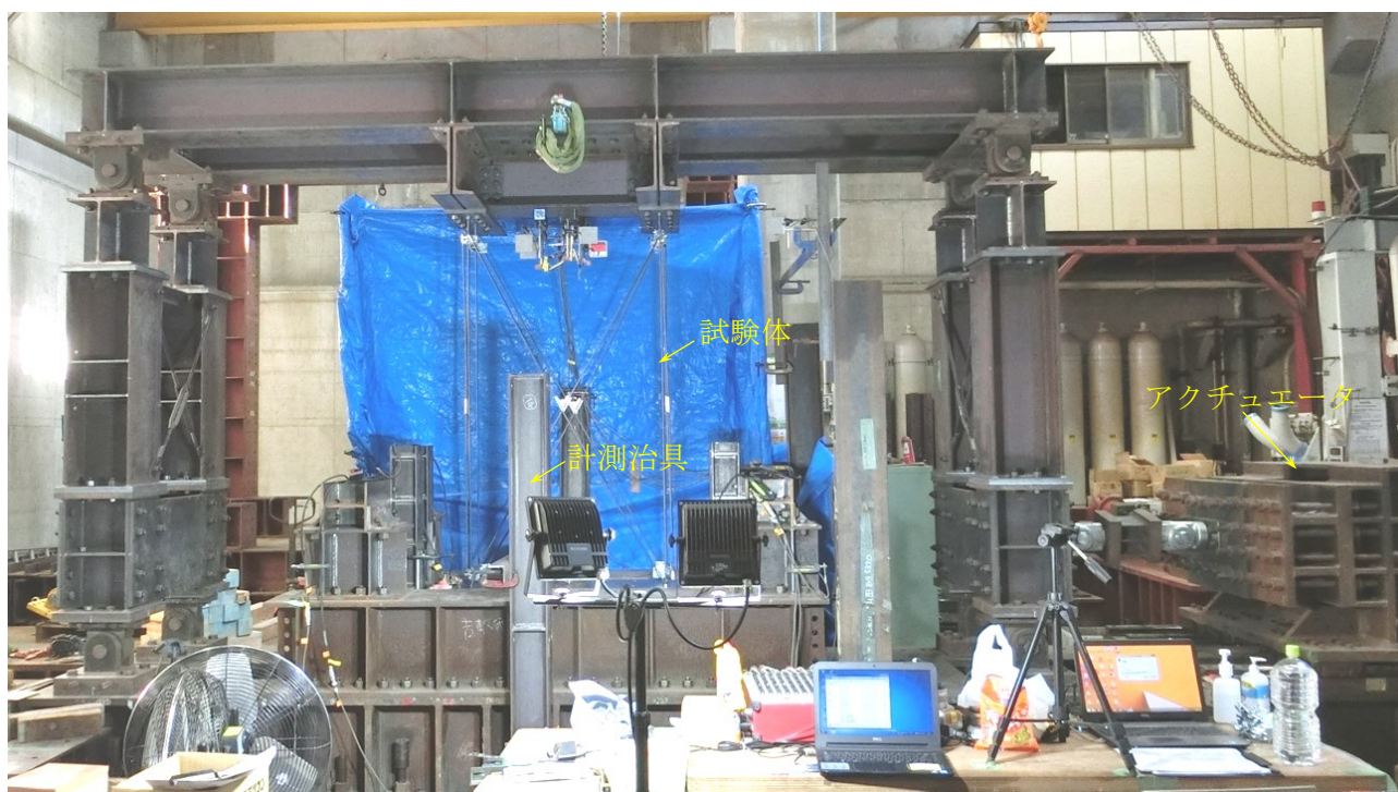
図3.13 実際のセットアップの様子（吊り支持部材の繰り返し載荷実験）
