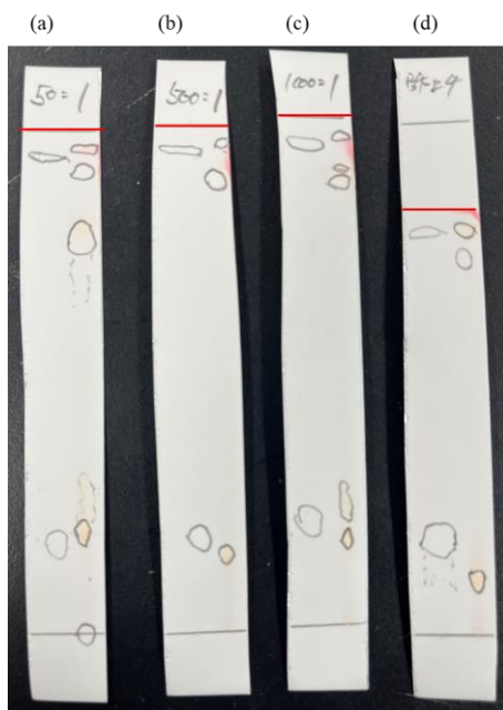
Figure 6-10 酢酸エチル：メタノール比を変更して展開した TLC のスポット位置 ; (a) 50 : 1、(b) 500 : 1、(c) 1000 : 1、(d) 100 : 0 ; (左) Mal、(右) 精製前の Dox-Mal
