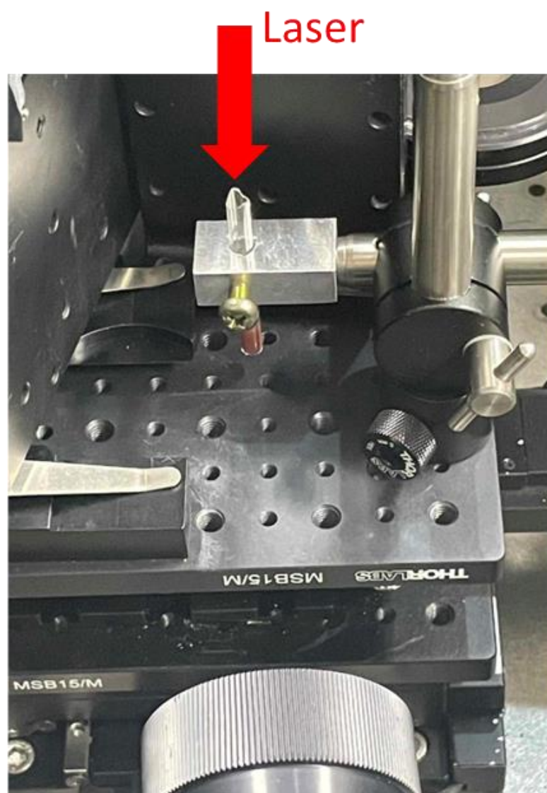
Figure 3-1 試料へのレーザーの入射の方向とカメラの位置
