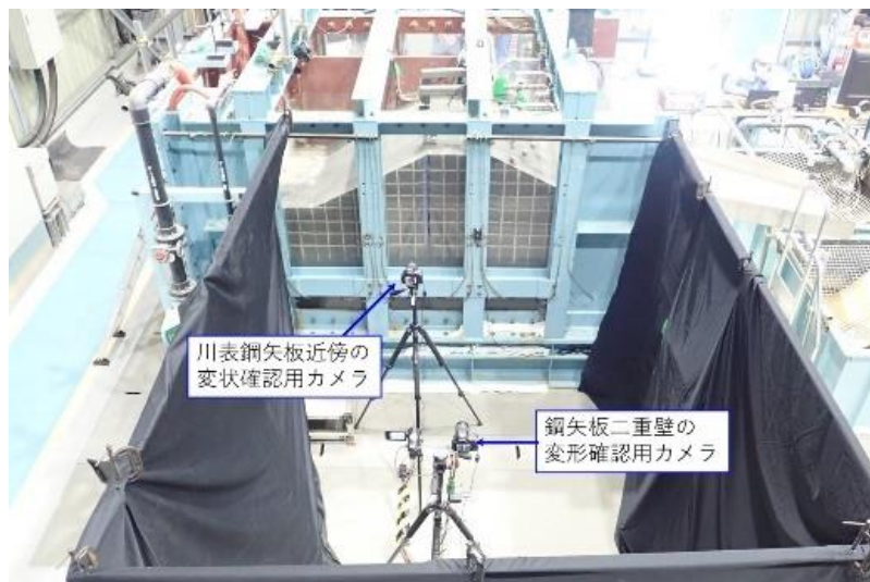
図 A-1. 境界部変状の確認用カメラ設置位置
