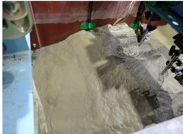
図 3.94 越水後の引水による川表のり面の変状
