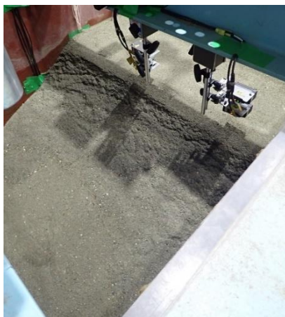
図 3.93 繰返し浸透後の引水による川表のり面の変状
