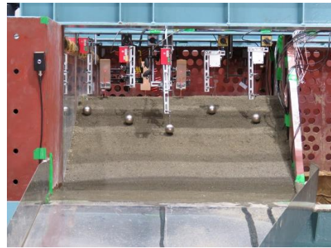
初期状態 (上図：断面 下図：正面) 第4サイクル終了時[D] (上図：断面、下図：正面) 図 3.68 越水時における堤防断面の形状変化 (L500t6C(鋼矢板二重壁))
