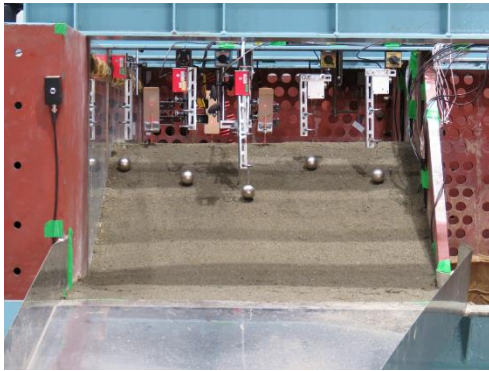
初期状態 (上図：断面 下図：正面) 第4サイクル終了時[D] (上図：断面、下図：正面) 図 3.68 越水時における堤防断面の形状変化 (L500t6C(鋼矢板二重壁))
