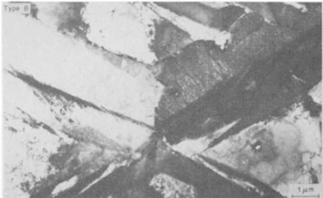
図 1-10 Fe-18Ni-1.0Cr-0.5C (wt%)合金で形成された バタフライマルテンサイトの電子顕微鏡写真 [44, 79] .
