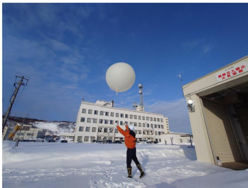
図 1-6 気象庁によるラジオゾンデ観測[30].
