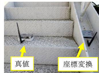
図3 センサの取付け(4S1の補正係数測定用)
